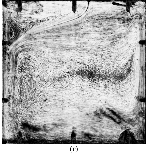
Рисунок 4.6 – Поля скорости в момент времени t = 0 с от начала кристаллизации (а – V_x ; б – -V_y ; в – |V| ) и структура течения в момент кристаллизации (г)
